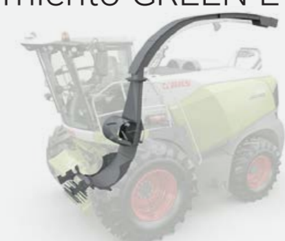
Flujo de material PREMIUM LINE con contracuchilla
