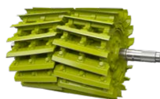
Funcionamiento con la totalidad de las cuchillas para longitudes de corte de cortas a medianas.
