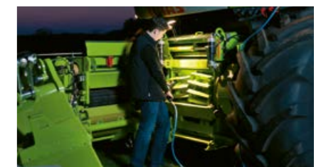
QUICK ACCESS hace que la inspección de los órganos picadores sea posible en pocos minutos.
