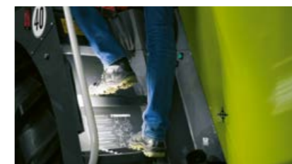
L'éclairage à LED du marche-pied sécurise l'accès à la cabine confort CLAAS.
