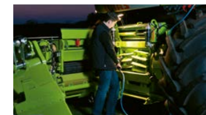
Le QUICK ACCESS permet l'inspection des organes de coupe en quelques minutes seulement.
