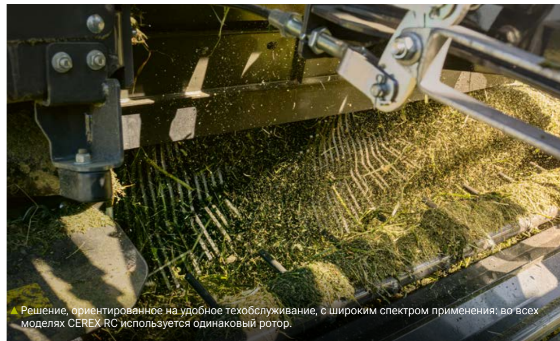
▲ Опускаемое режущее днище PRO активно адаптируется под поток массы.
