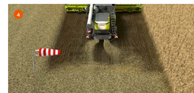
3 Датчики в задней части машины определяют интенсивность бокового ветра.
