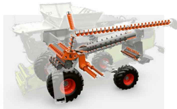
Компоненты PREMIUM LINE с повышенной износостойкостью.
