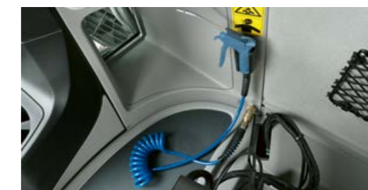
Для быстрой очистки в любое время — пневматический пистолет в кабине
