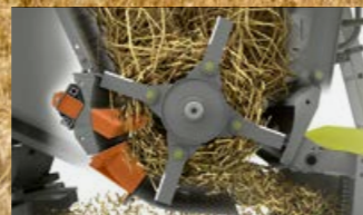
Kontra-nož i zakretni osnovni element u sjeckalici SPECIAL CUT (Posebno rezanje)
