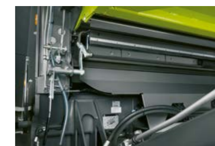
Veliko korito hvatača kamenja može se lako otvoriti i isprazniti.
