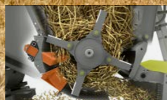
Faste knive og svingbart svøb i SPECIAL CUT snitteren
