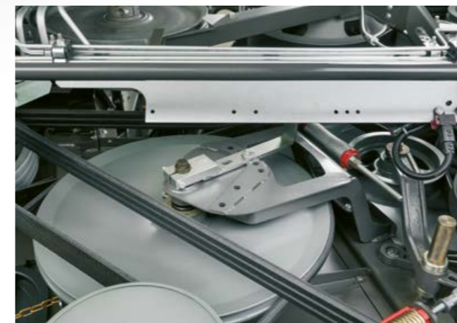
Profondeur de piquage des doigts dans le matelas de paille réglable
