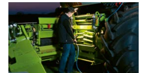
QUICK ACCESS leidžia patikrinti smulkinimo mechanizmą per kelias minutes.
