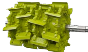
Pusės ilgio peilių konfigūracija dvigubam pjautosių ilgiui ir labai sklandžiam, vienodam augalų masės tiekimui.
