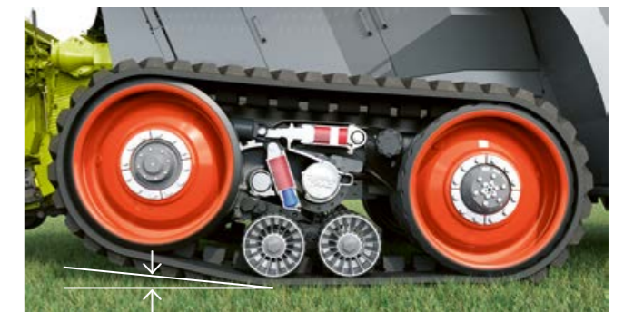
Kontakto plotas 66 %: važiuojant posūkiuose, vikšrų atraminiai ritinėliai pakeliami.
