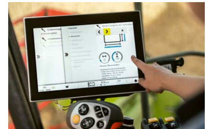
Entrada de las medidas de la bandeja de pérdidas en CEBIS
