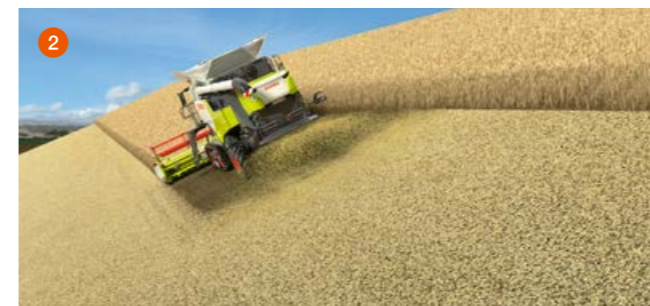
1 En el caso de pendiente, se adapta automáticamente la dirección de tiro. 2 El material picado es repartido homogéneamente por toda la anchura de trabajo.
