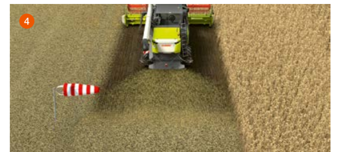
3 Sensores en la parte trasera de la máquina miden la intensidad del viento lateral. 4 Se compensa la dirección de tiro del material picado.
