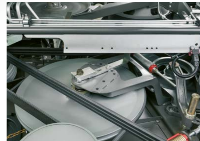
Piikkien pöyhintäsyvyyttä olkimatossa voidaan säätää.
