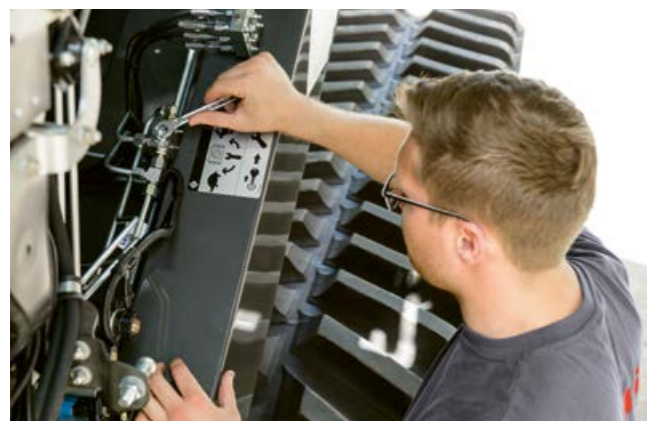
Puintikelan alennusvaihteiston molemmat nopeusalueet vaihdet käsi­käyttöisellä hydraulikkaventtiilillä.
