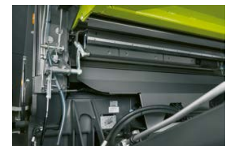
Die große Steinfangmulde lässt sich einfach öffnen und entleeren.
