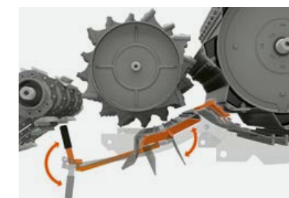
Vorkorbklappen entgrannen und entspelzen Ihr Korn.
