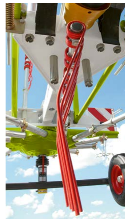
Стандартные 9-миллиметровые пальцы в моделях 450, 420 и 370 чрезвычайно прочны и подходят для заготовки как сенажа, так и сена.
