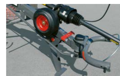
Подвижная навеска скобой, качающаяся в поперечном направлении, позволяет выполнять разворот на 80°.
