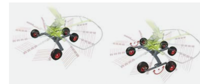
Идеальное направление пальцев: благодаря шасси ротора, которая расположена максимально близко к пальцам по периметру.
