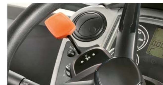
Механизмом реверсирования REVERSHIFT оператор управляет кончиками пальцев.
