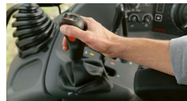
Благодаря четырем ступеням переключения под нагрузкой во многих случаях не требуется смена групп.
