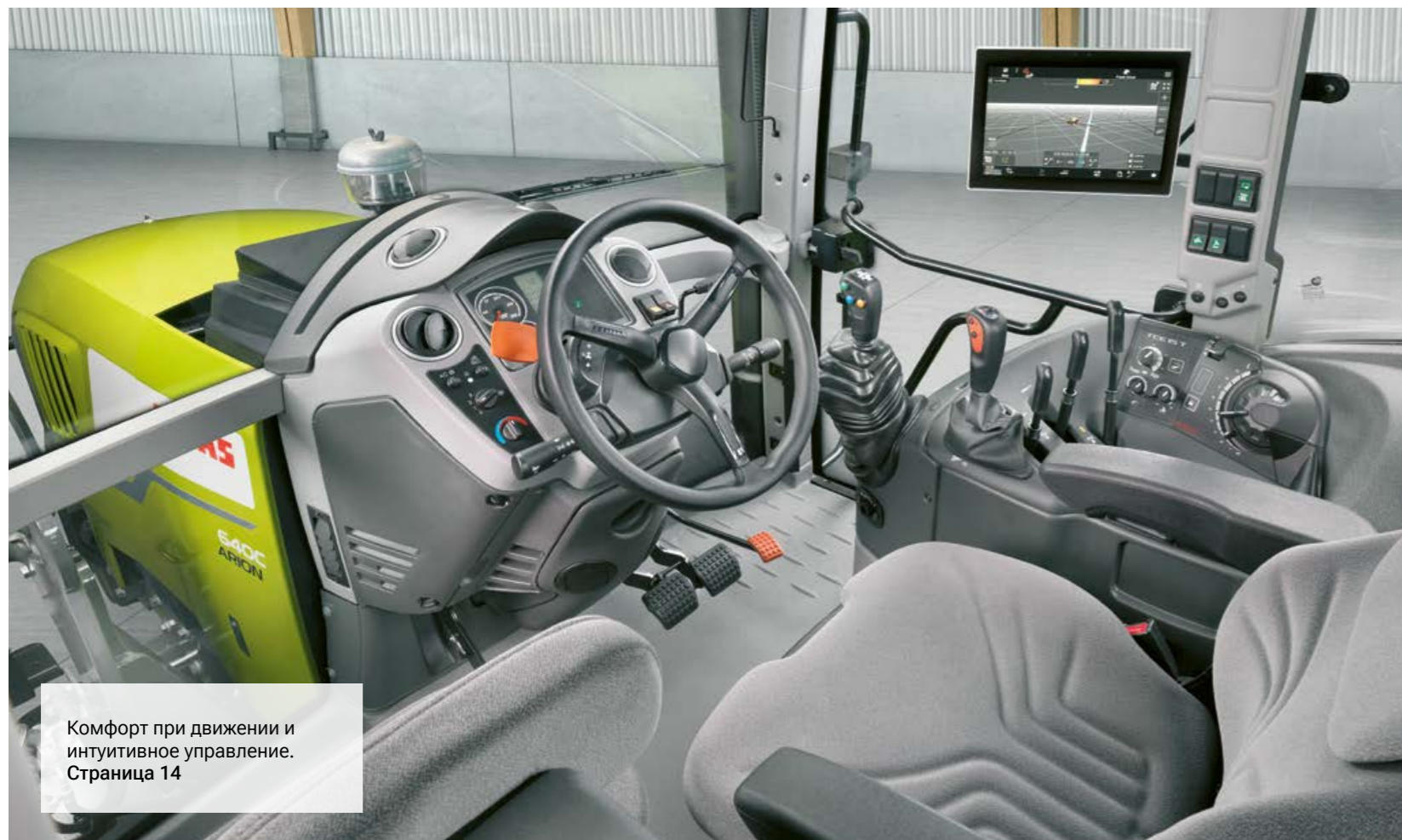
Переключение 16 передач нажатием кнопки на рычаге ручного управления подачей топлива. Страница 8
