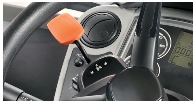
Механизмом реверсирования REVERSHIFT оператор управляет кончиками пальцев.
