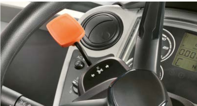
Реверсивною коробкою передач REVERSHIFT ви керуєте самими кінчиками пальців.
