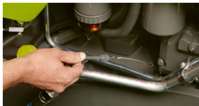
Доступ до щупа для вимірювання рівня моторної оливи можливий також із фронтальним навантажувачем.
