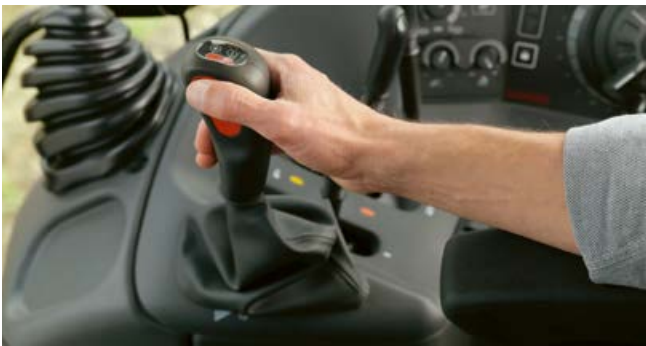
Чотири ступені перемикання під навантаженням у багатьох випадках звільняють вас від зміни груп передач.
