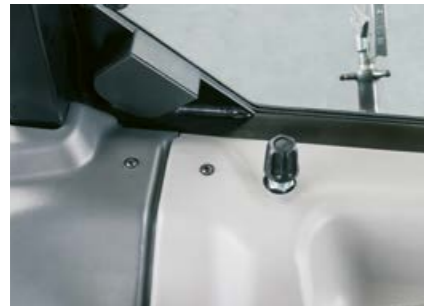
De maximale opbrengst van mechanisch regelventiel 3 kan met een handgreep vanuit de cabine worden begrensd.
