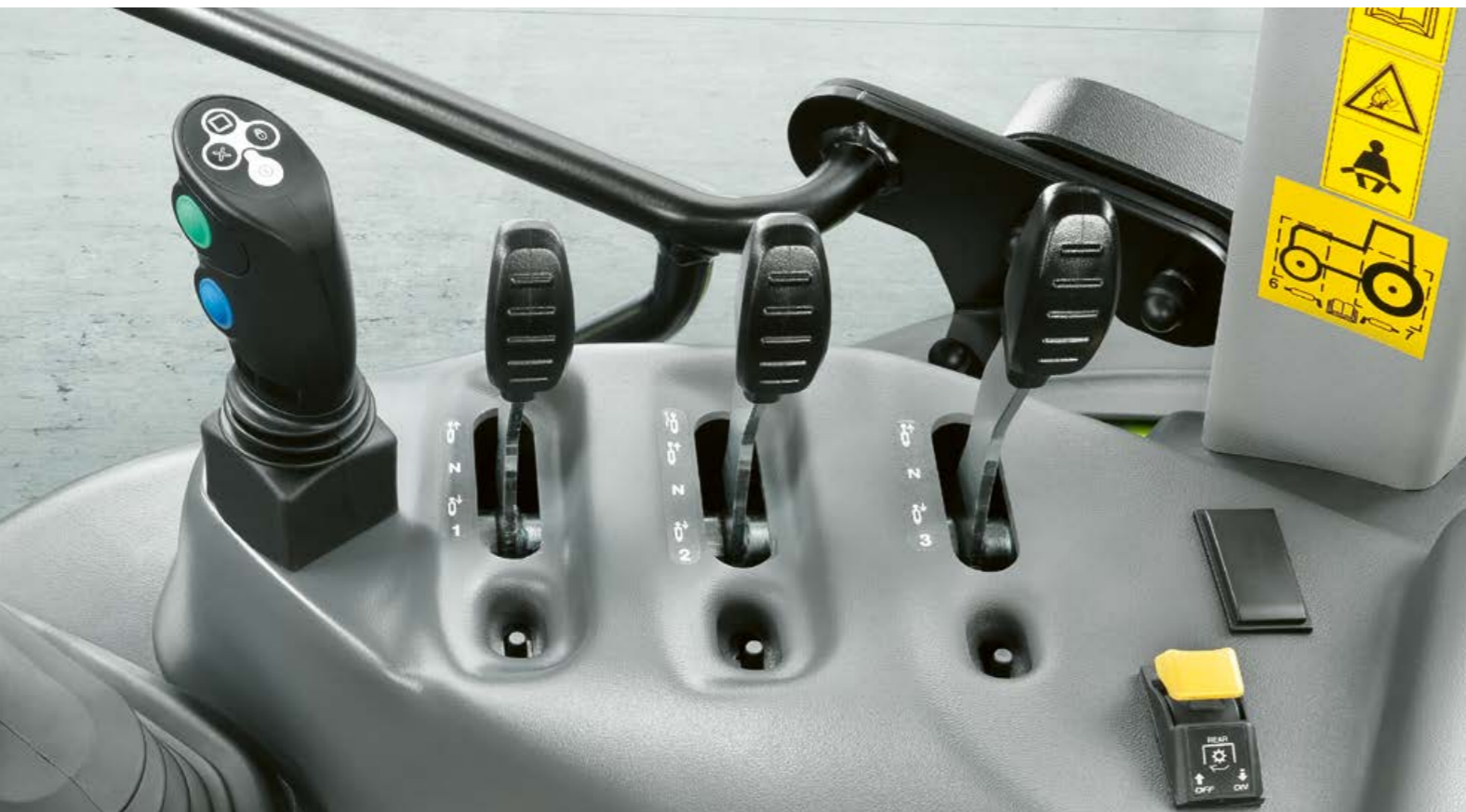
De maximale opbrengst van mechanisch regelventiel 3 kan met een handgreep vanuit de cabine worden begrensd.
