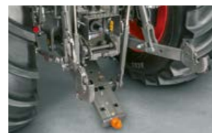
Als alternatief voor de aankoppelbok is een pickup hitch leverbaar.
