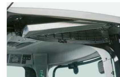
Cabineluchtfilter in het cabinedak is gemakkelijk bereikbaar.
