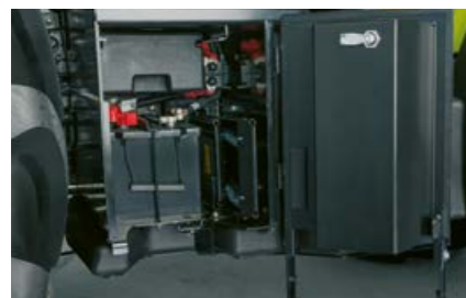
Aan de rechterzijde in de opstap zijn de accu en een opbergvak voor gereedschap ondergebracht.
