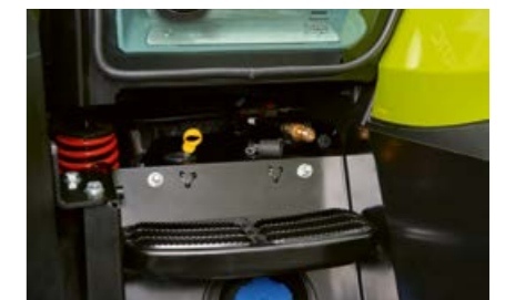
Links in de opstap bevindt zich een persluchtaansluiting.
