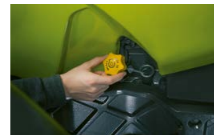
Met een gesloten motorkap kan het oliepeil worden gecontroleerd en olie worden bijgevuld.
