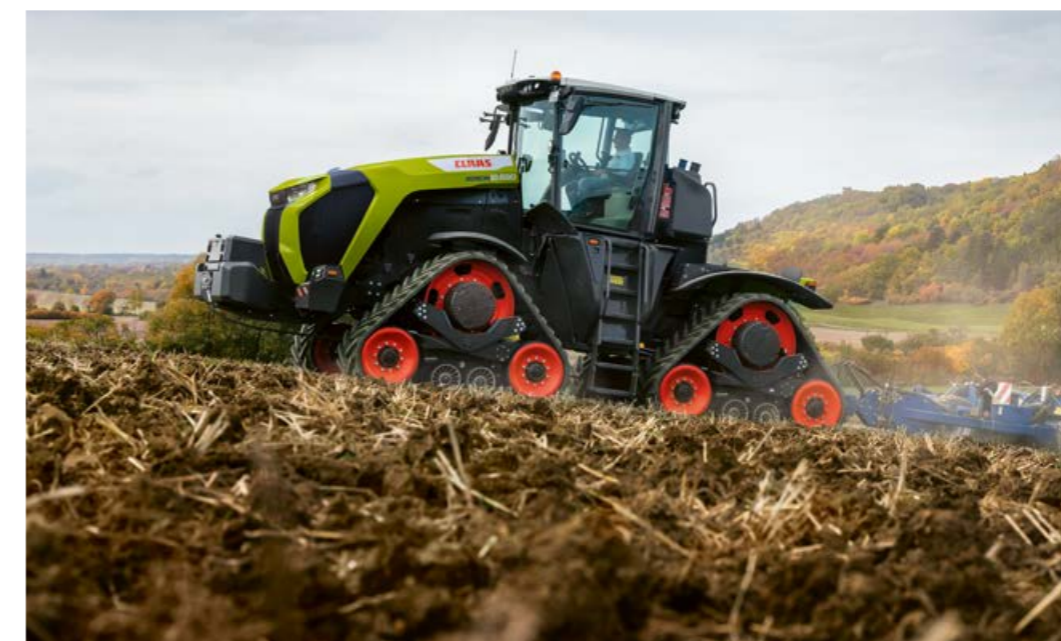
◀ Das Federungskonzept – angefangen vom Raupenlaufwerk mit Dämpfungseigenschaft über die 4-Punkt-Kabinenfederung bis hin zum gefederten Premiumsitz – sorgt im XERION für einen besonders hohen Fahrkomfort.
