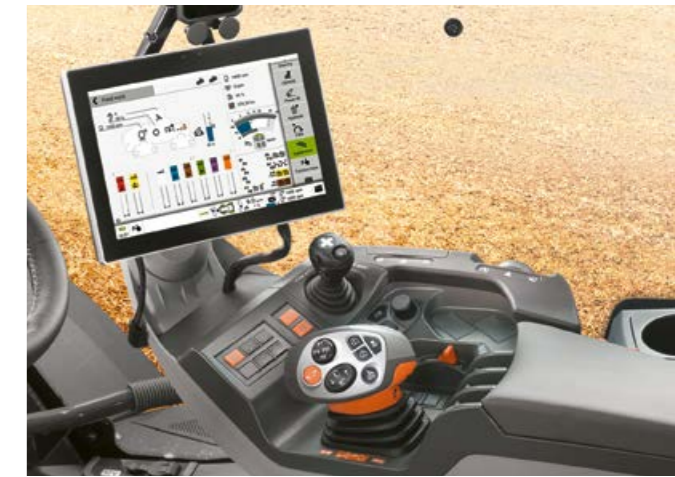
▲ Leichte Bedienung. Intuitive Maschineneinstellung und bester Bedienkomfort mit dem CEBIS Bordinformationssystem und dem CMOTION Multifunktionsgriff.
