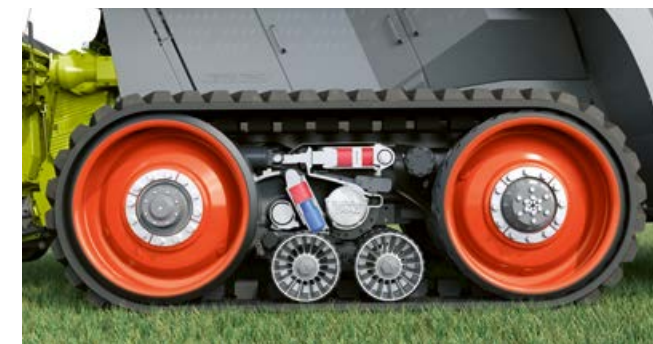
100% kontaktpind: sõidurullik on maapinnaga täiskontaktis.
