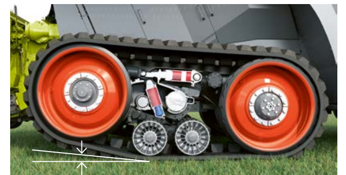
66% kontaktpind: kurvis tõstetakse sõidurullik üles.
