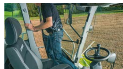
Istmelüliti lülitab esiseadme ja peajami automaatselt välja.
