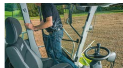
Az üléskapcsoló automatikusan kikapcsolja az adaptert és a fő hajtóművet.
