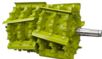
Harmadolt késszám (csak 36 késes dobnál) nagyon hosszú szecskahosszhoz, szimmetrikus terménytovábbítással.
