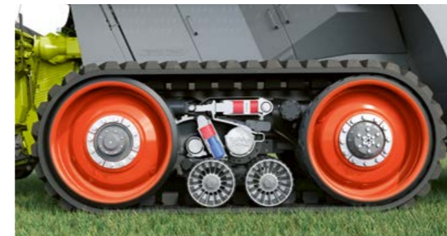
100% felfekvási felület: Az elülső hajtókerék teljes mértékben érintkezik a talajjal.
