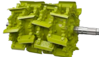
Félhosszúságú kések a duplaszecskahosszhoz, homogén terménytovábbítással.
