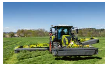
Kompaktiškas prikabinimo įtaisas užtikrina didelę prošvaisą galulaukėse.
