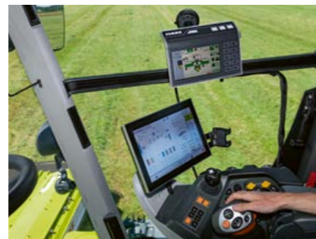
Patogus valdymas, pavyzdžiui, naudojant įvairius ISO-BUS terminalus ir ISOBUS funkcinis mygtukus ant važiavimo greičio valdymo svirties.
