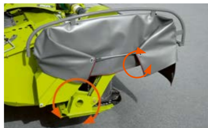
Dėl žemai esančio posūkio taško, DISCO tiksliai kopijuoja paviršių.
