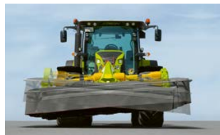
Laisvai švytuojanti pakaba kompensuoja lauko paviršiaus nelygumus statmenai važiavimo kryptčiai.
