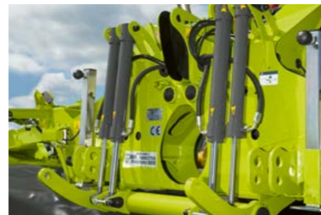
Standartiniai ACTIVE FLOAT kėlimo ir pakabos cilindrai užtikrina patikimą velėnos apsaugą.
