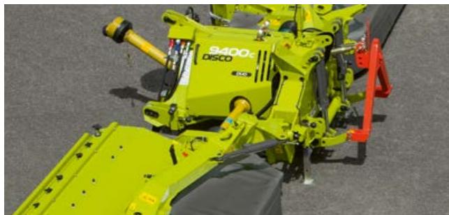
Naudojant hidraulinę apsaugą, leidžiančią atsilenkti atgal, galima dirbti nesusitojant – atsitrenkus į kliūtį, šienapjovė pasisuka ir automatiškai grįžta į pradinę padėtį.
