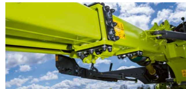
Dvi hidraulinio būdu valdomos teleskopinės strėlės. Bepakopis reguliavimas leidžia užtikrinti optimalų DISCO 1100 COMFORT persidengimą.
