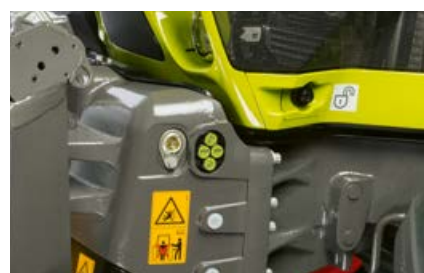
Comenzi externe pentru tiranții față și o supapă hidraulică (în funcție de echipamentul montat)
