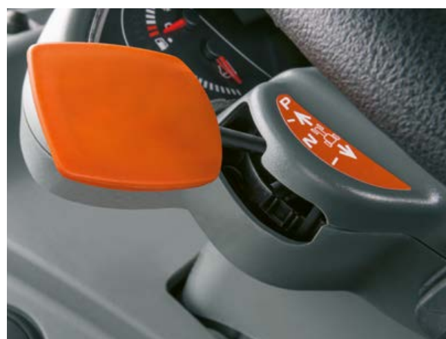
Manetă REVERSHIFT cu frână de parcare electronică disponibilă
