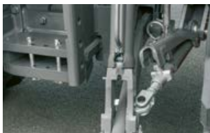
Stabilizatori tiranți spate automați
