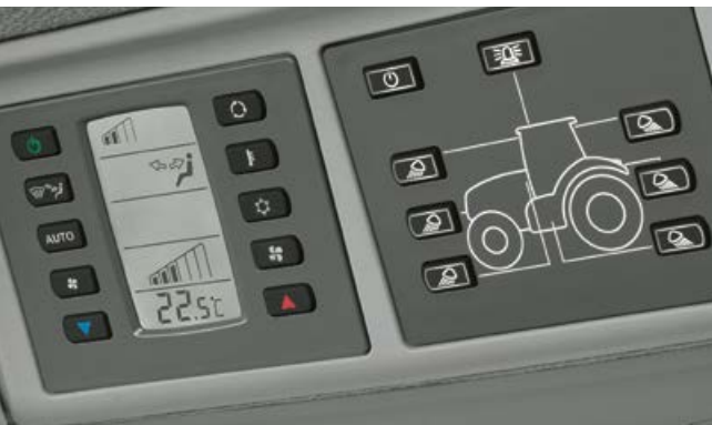
Un sistem de climatizare complet automat este disponibil pe lângă cel cu comandă manuală, care distribuie în mod plăcut fluxul de aer în cabină.
