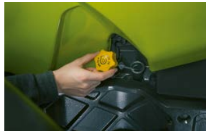
Nivelul uleiului poate fi verificat și completat când capota este închisă
