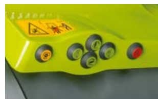
Välised juhtseadised tagarippsüsteemile, jõuvõtuvõlliile ja ühele vabalt valitavale hüdrojagajale (ainult CEBISel).
