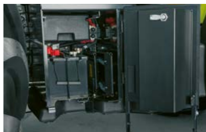
Aku ja tööriistalaegas on paigutatud ligipääsetavasse kohta parempoolse trepi juures.
