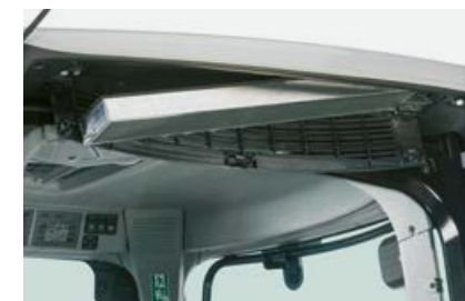
Kabiini katuses paiknevale kabiiniõhu filtrile pääseb lihtsalt ligi.
