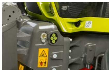
A frontfüggesztés és kihelyezett kör külső működtetése (felszereltségtől függően)
