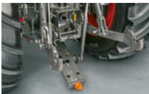
A vonóhorog alternatívájaként Hitch-hakenkuplung is rendelhető
