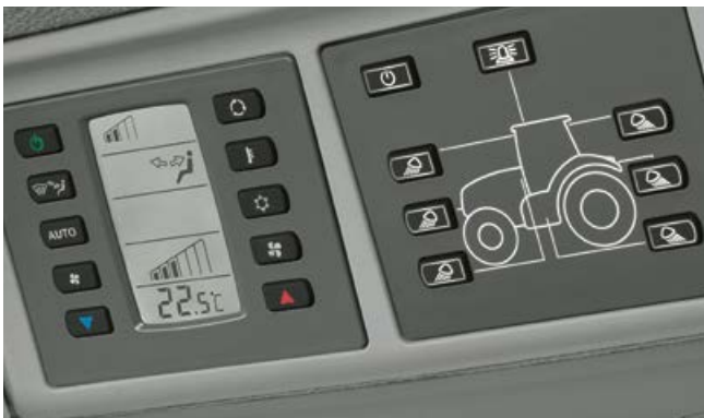
A manuális klíma helyett rendelhető automata klíma is, amely a kellemesen hűvös levegőt a fülkében egyenletesen biztosítja.
