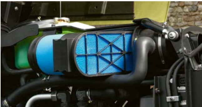
El filtro de aire de grandes dimensiones garantiza una larga vida útil.
