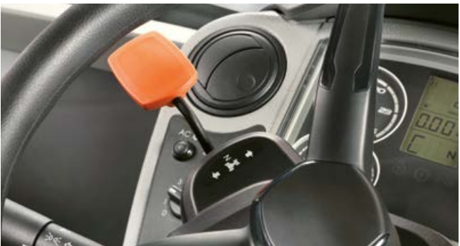
El engranaje inversor REVERSHIFT lo acciona fácilmente con las yemas de los dedos.
