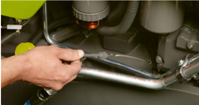
La varilla del nivel de aceite del motor también ofrece un buen acceso con cargador frontal.
