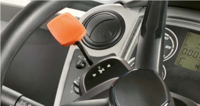
El engranaje inversor REVERSHIFT lo acciona fácilmente con las yemas de los dedos.
