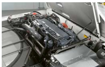
TRION 760 ir 750 modeliuose sumontuoti efektyvūs, šešių cilindrų MAN varikliai, kurių galia iki 507 AG, o darbo tūris 12,4 l.
