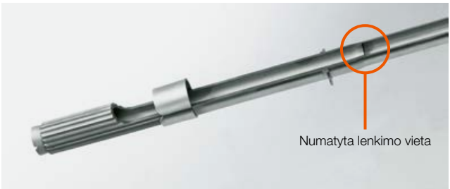
Optimali apsauga: atsitraukus į kiltį, pirštų laikikliai užlinksta iš anksto numatyto lenkimo vietoje.
