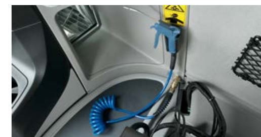
Kabiinis olev õhupüstol sobib vahepealseks kiireks puhastamiseks.
