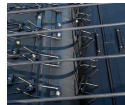
Az ujjak gyorsan felveszik a betakarított terményt, és gyorsan továbbadják.
