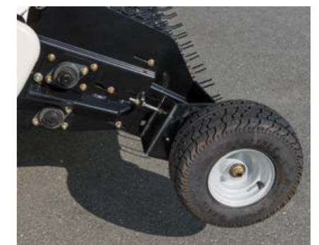
A munkamélység támkerékekkel állítható be
