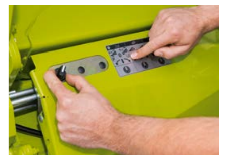
Parkoló- és tisztítási pozíció beállítása közvetlenül a vágóasztalon
