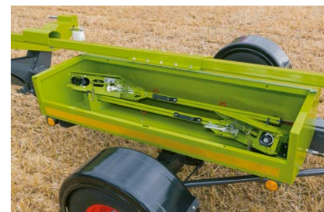
A repcekaszák biztonságos tárolása érdekében minden szállítókoszlik zárható szállítódobozzal van felszerelve.
