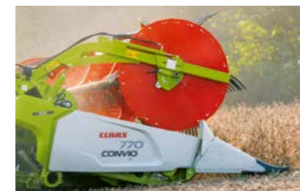
Rugós terhelésű rendváltók az alacsonyan fekvő termények betakarításához
