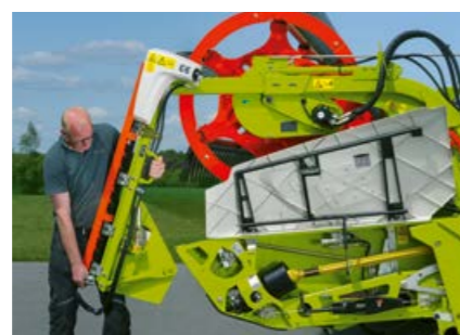
Gyors átszerelés repcére A hidraulikus hajtású repcekaszák felszerelése szerszám nélkül és percek alatt elvégezhető. Ha a repcekaszák fel vannak szerelve, az oldalsó csigák automatikusan aktiválódnak. Ezzel a vágóasztal készen áll a repce betakarítására.
