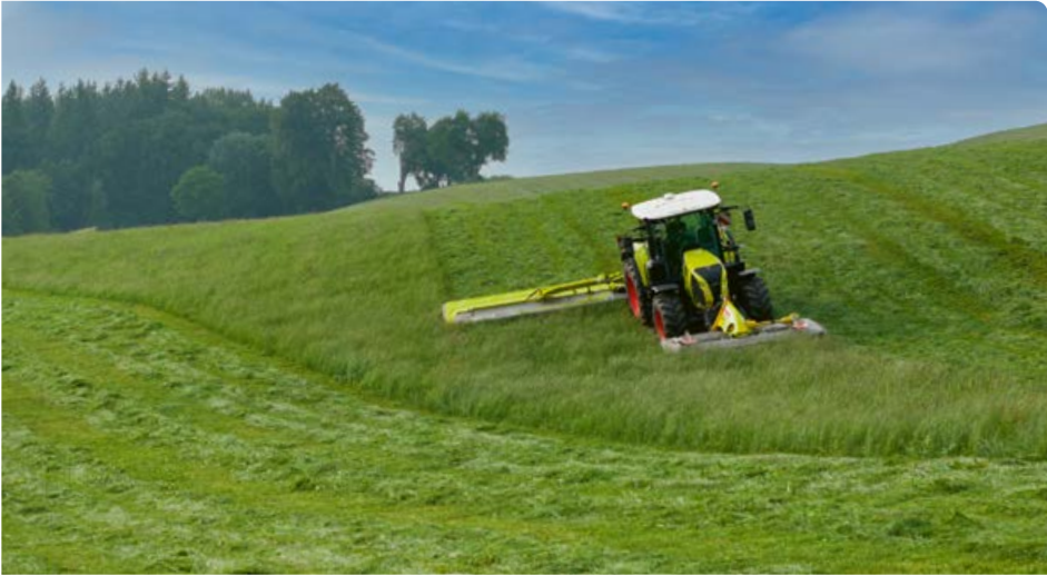
◀ Urmărirea conturului solului chiar și pe pante. Unitățile de cosit din seria CONTOUR pivotează liber și urmează cu precizie conturul solului.
