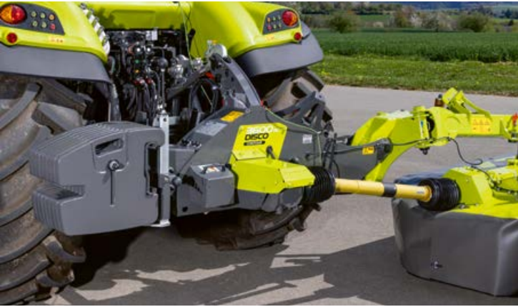
▼ Contragreutățile opționale oferă mai multă stabilitate, un confort sporit la rulare și desfășurarea în siguranță pe teren deluros.
