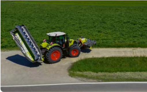
◀ I to největší DISCO se složí na malé: kompaktní přepravní poloha díky pracovnímu záběru 4,20 m.
