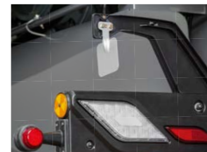
Automatikus terítésirány-szabályzás szenzor
