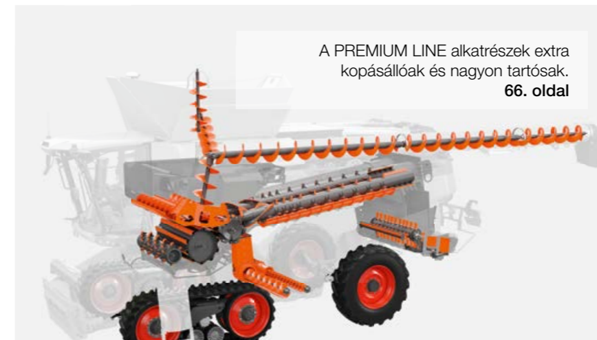
A HP - Kanál és a V - Kanál ferdefelhordók lehetővé teszik a vágási szög beállítását. 16. oldal
