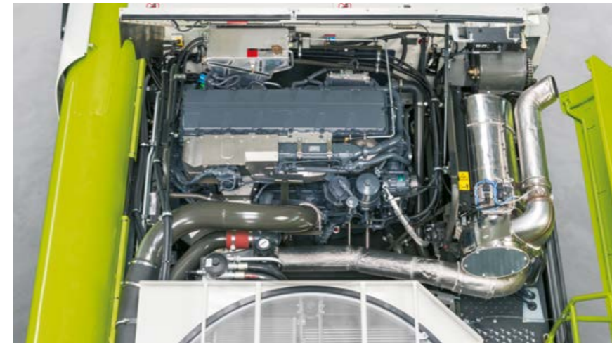
MAN D42 motorok 581 kW / 790 LE teljesítménnyel a LEXION 8900 / 8800 modellekhez.
