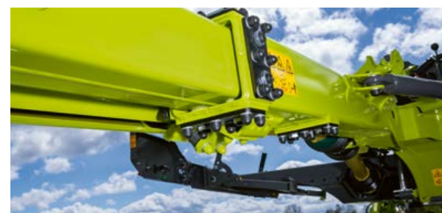
Dvě hydraulicky ovladatelná teleskopická ramena s plynulým nastavením pro optimální překrývání u modelu DISCO 1100 COMFORT.
