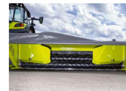
Dodatečné usměrňovací plechy pro užší řádek.
