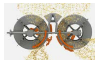
Radiális törekoszlató a hatékony terítéshez, minimális energiafelhasználással.
