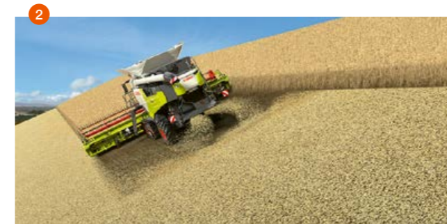
1 Lejtőmenetben a szórás irányát automatikusan kiigazítja. 2 A szecskázott anyagot egyenletesen teríti szét a teljes munkaszélességben.
