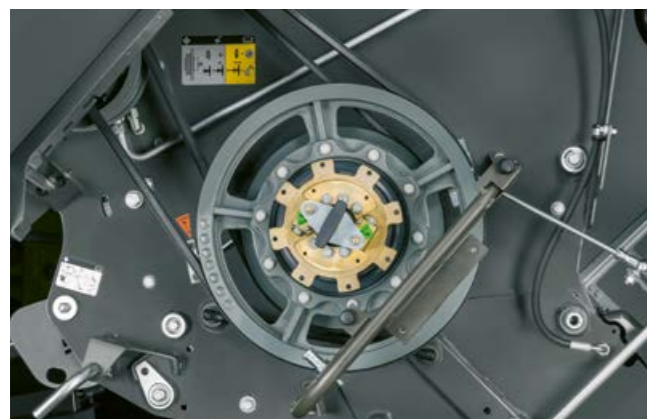
A szalmaszeccskázó fordulatszáma egyszerűen, gyorsan és szerszámok nélkül a munkához igazítható.
