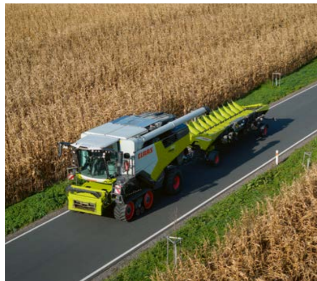
Minden TERRA TRAC hevederes járószerkezet képes akár 30 km/h-val közlekedni a közúton, kényelmesebben mint a kerekes gépek.
