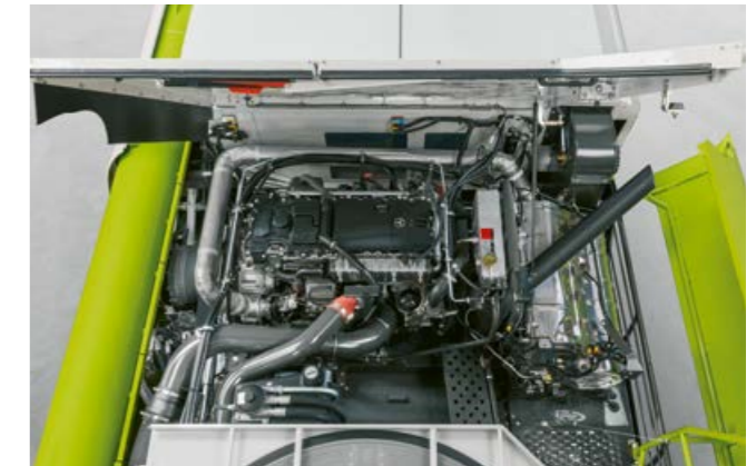
Mercedes-Benz OM 470 mit 300 kW / 408 PS für LEXION 6700
