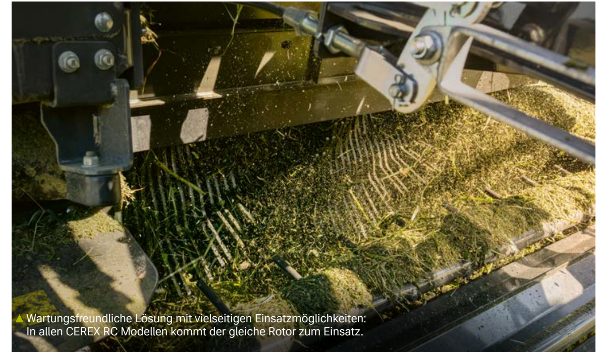
▲ Der absenkbare Schneidboden PRO passt sich aktiv dem Gutfluss an.
