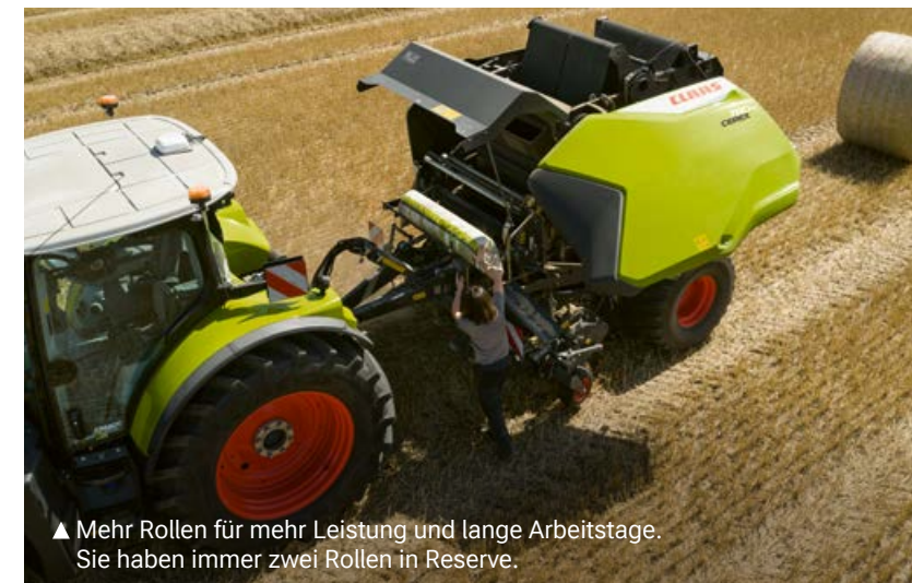
► Einfacher, zeitsparender Rollenwechsel ohne umständliches Einfädeln.
