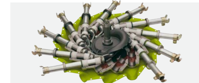
Fiabilitate fără întreținere: componenta principală a modelului LINER este cama care rulează într-o baie de ulei.
