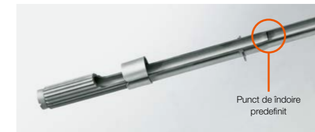
Cea mai bună protecție: în cazul unei coliziuni, brațele sunt îndoit în mod controlat, într-un punct definit.
