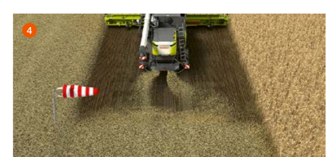
3 Masina tagaosas asuvad andurid tuvastavad külgtuule tugevuse. 4 Hekseldatud materjali viskesuunda tasakaalustatakse.
