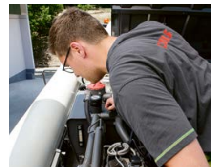
Kõiki õlitasemeid on lihtne visuaalselt kontrollida.
