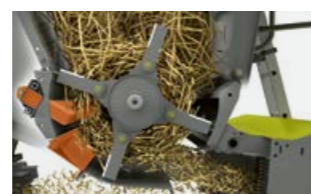
Vastunuga ja pööratav põhjaelement SPECIAL CUTi hekseldis.
