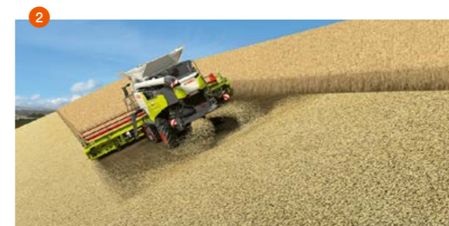
1 Kui masin töötab nõlval, siis kohandatakse viskesuunda automaatselt. 2 Hekseldatud materjal jaotub ühtlaselt üle kogu töölaiae.
