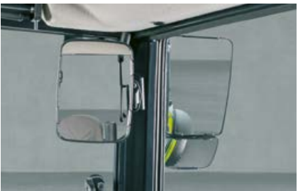
Un rétroviseur grand angle est disponible en plus du large rétroviseur pour une sécurité accrue sur la route.
