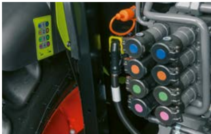
Les coupleurs arrière sont faciles à reconnaître avec leurs codes couleurs et l'autocollant installé à proximité.
