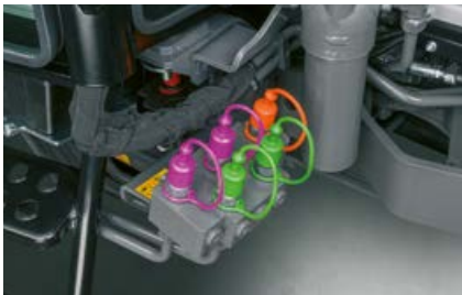
Jusqu'à quatre coupleurs hydrauliques et un retour libre sont disponibles à l'avant.
