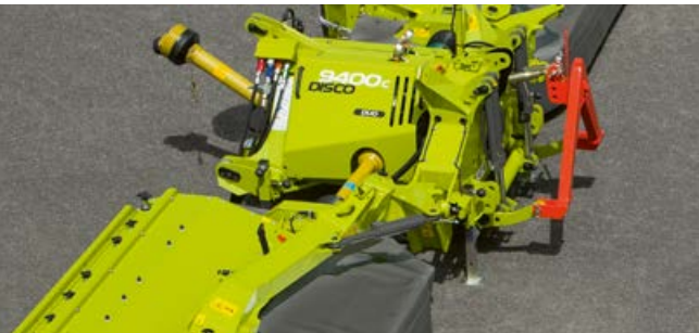
Protecție hidraulică non-stop împotriva coliziunii: în eventualitatea unei coliziuni, cositoarea pivotază în sus și peste obstacol și revine automat la poziția inițială.
