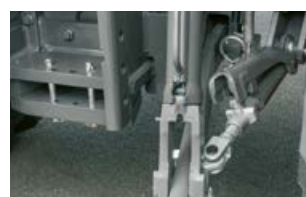
Automatické stabilizátory dolních táhel
