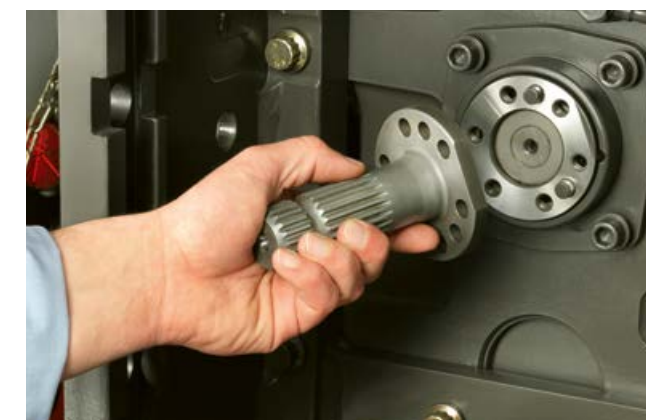
Snadná výměna koncovky vývodového hřídele
