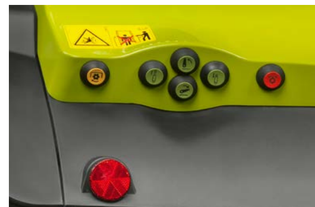
Vnější ovládání zadního vývodového hřídele
