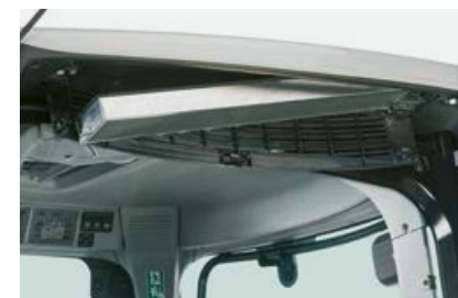
Snadná přístupnost ke vzduchovému filtru kabiny na střeše
