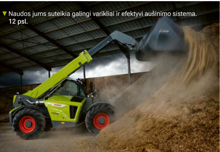
▼ SCORPION kabina siūlo įspūdingą ergonomiką ir puikų matomumą visomis kryptimis. Pasirenkamos, didelės raiškos vaizdo kameros perduoda ryškius darbo aplinkos vaizdus, kurie atvaizduojami spalvotame ekrane. 18 psl.
