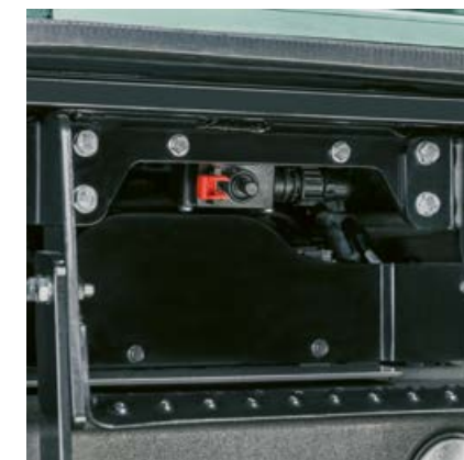
Odłącznik akumulatora jest wygodnie umieszczony przy lewym wejściu.
