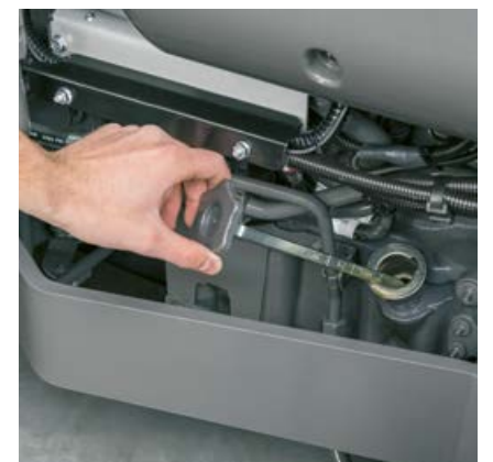
Kontrolę poziomu oleju i jego uzupełnienie można wykonać przy opuszczonej masce z prawej strony AXOS 2.
