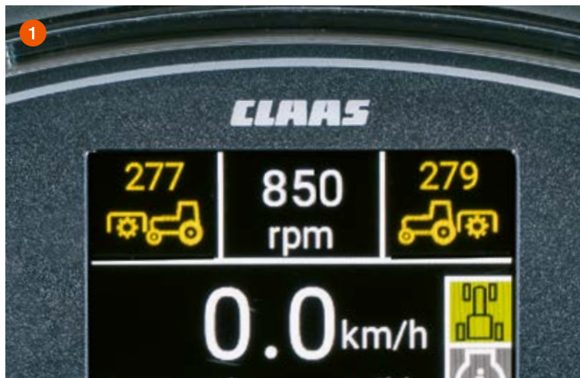
1 Cyfrowy wskaźnik liczby obrotów dla przedniego i tylnego WOM umożliwia pracę z zawsze odpowiednią liczbą obrotów.
