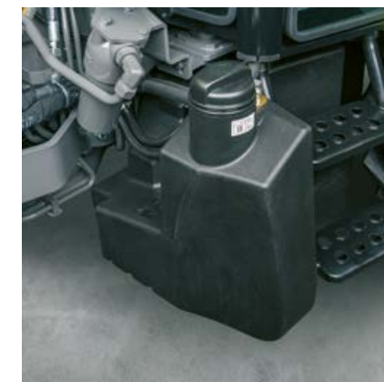
Zbiornik paliwa 105 l i zbiornik mocznika 10 l zapewniają wystarczający zasięg nawet w długie i intensywne dni pracy.
