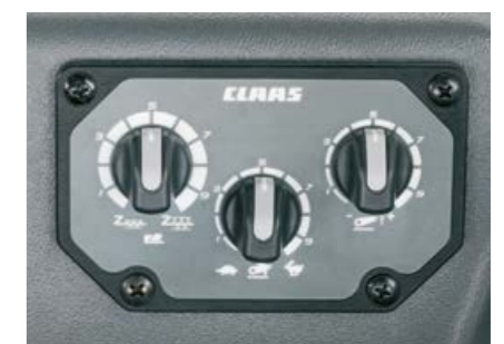
O controlo da tração, a velocidade de descida e o limite de elevação podem ser confortavelmente definidos na consola direita.
