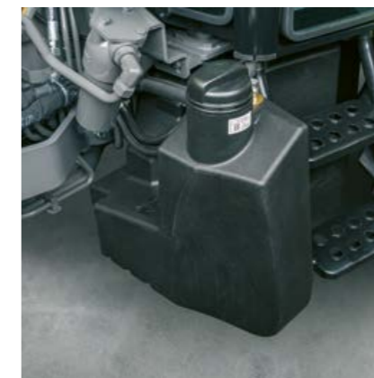
O depósito de diesel de 105 l e o depósito de ureia de 10 l permitem uma autonomia suficiente, mesmo em dias de trabalho intenso.
