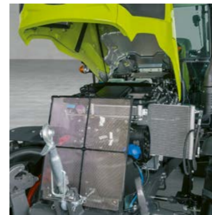
O radiador e a respetiva grelha podem ser retirados num instante para inspeção e limpeza.
