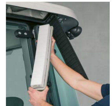
O filtro de ar da cabina está muito acessível do exterior para limpeza, facilitando a refrigeração do ambiente na cabina.
