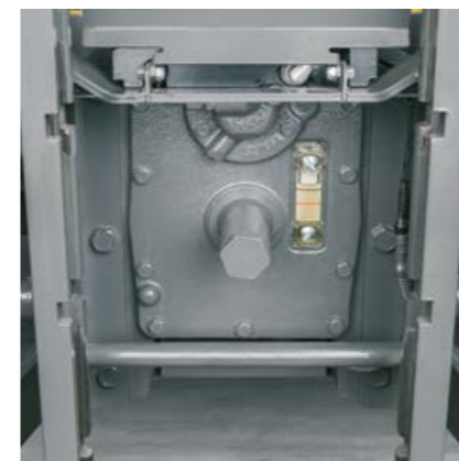
É possível verificar o nível do óleo da transmissão e do óleo hidráulico num visor junto à tomada de força traseira.
