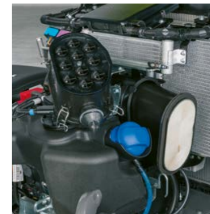
O filtro de ar PowerCore® está acessível na dianteira sob o capot, reduzindo os intervalos de limpeza.
