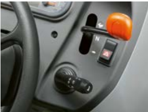
Existe, opcionalmente, um apoio mecânico à direita do volante ou a confortável transmissão de carga bifásica TWINSHIFT, que é controlada através da alavanca das mudanças.
