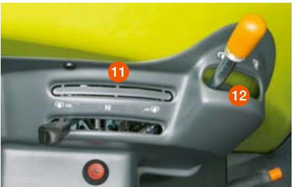
A tomada de força é ativada com suporte hidráulico de série. Em máquinas com equipamento REVER-SHIFT a ativação da tomada de força eletrónica é opcional.
