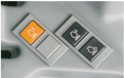
Os trabalhos com o veio de tomada de força são realizados muito facilmente com o ELIOS 2 – graças à memória de rotações do motor de série.
