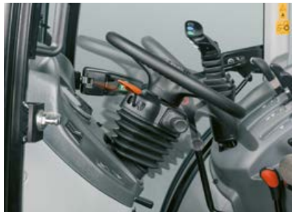
A coluna de direção oscilante e extensível permite adaptar à posição do condutor.
