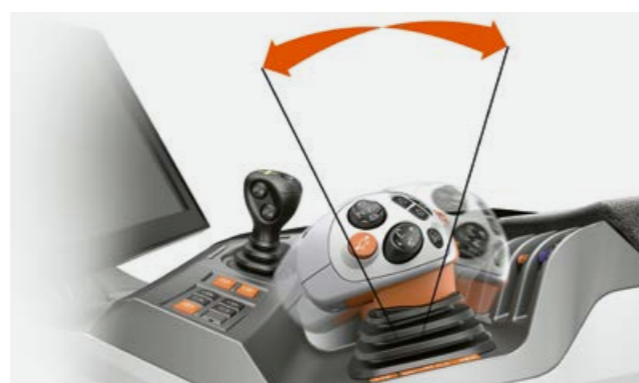
Progressivno upravljanje s tehnologijo brezstopenjskega menjalnika CMATIC.
