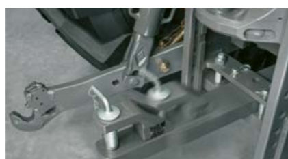
Pri različicah z nihajnim priklopom je mogočih več položajev, izvlečeni izboljša okretnost.
