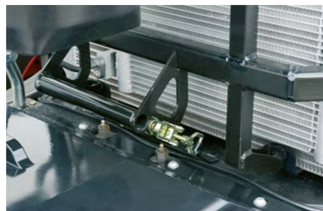
Točke za mazanje sprednje preme pred hladilnikom za optimalno dostopnost.
