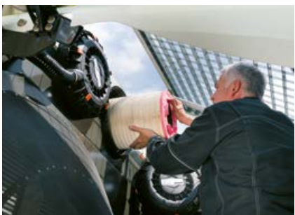
Cambio del filtro de aire sin herramientas
