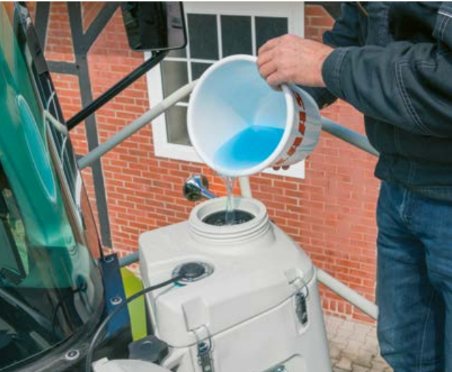
Relleno del depósito de aditivos de ensilado
