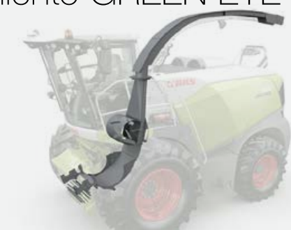
Flujo de material PREMIUM LINE con contracuchilla
