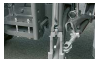
Automatyczne stabilizatory cięgieł dolnych
