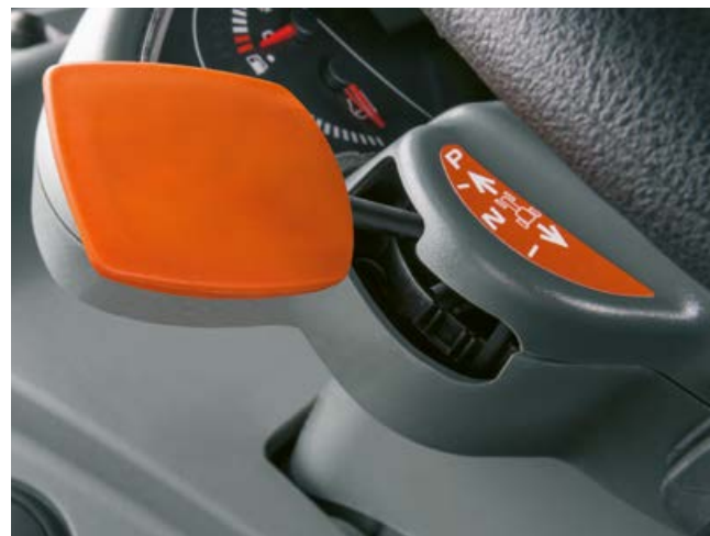
Dostępna dźwignia zmiany biegów REVERSHIFT z elektronicznym hamulcem postojowym
