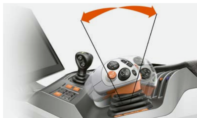
Obsługa progresywna dzięki technologii bezstopniowej przekładni CMATIC
